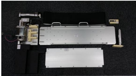
設計組立前の力計測ユニット・ベルトユニットの部材
